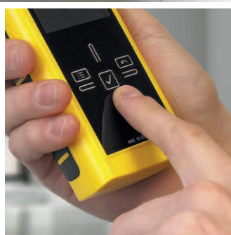
La surface en verre spécial Blanview d'un seul bloc des T210 et T260 est très résistante aux rayures et présente un panneau de commande tactile capacitif.
